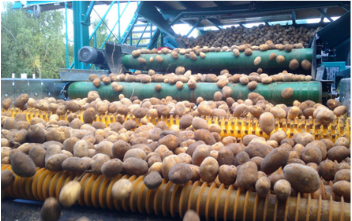
↗ In der Kartoffelannahme findet eine grobe Entsandung statt und Fremdkörper werden aussortiert.
